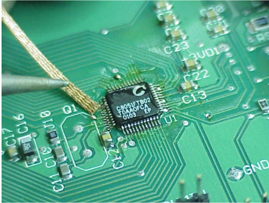
图 7. 涂焊剂；从引脚吸除焊锡
